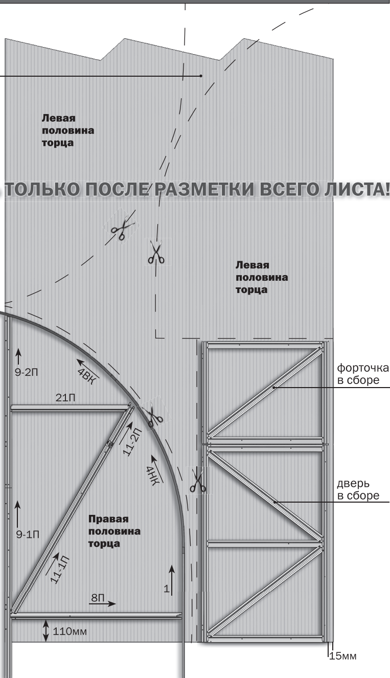
Рис. 4 Расположение деталей при раскрое.
